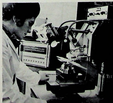
Bild 7. Rechnergesteuerte Vorrichtung zum Ultraschall-Kontaktieren von IS
